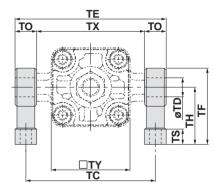
(mm) Bore size TA Part no. TU TE TL TC TX TO TR TT TS TH TF TY Z TD-H10 (Hole) (mm) 15<sup>+0.070</sup> 40 80 60 10 102 85 119 17 9 17 12 45 60 62 93 CA2-S04 15 +0.070 50 80 60 10 17 9 45 60 74 103 112 95 129 17 12 180+0.070 CA2-S06 63 100 70 15 130 110 150 20 11 22 14 73 90 107 25<sup>+0.084</sup> 80 120 15 166 140 192 13.5 24 17 75 100 110 129 MB-S10 25<sup>+0.084</sup> 100 120 188 162 214 13.5 17 100 130 135
