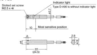
D-A90V, D-A93V, D-A96V
