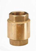
Corpo in ottone. Piattello in nylon. Tenuta in NBR. Molla in acciaio inox. Temperature minima e massima di esercizio: -20°C, 100°C. Attacchi filettati ISO228 (equivalente a DIN EN ISO 228 e BS EN ISO 228).
