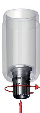
Lo scarico della condensa Manuale Semiautomatico è normalmente nella posizione aperta cioè scarica automaticamente la condensa quando è assente la pressione nella tazza, premendo la manopola è possibile scaricare la condensa in presenza di pressione, ruotando la manopola in senso antiorario lo scarico è nella posizione chiusa.
