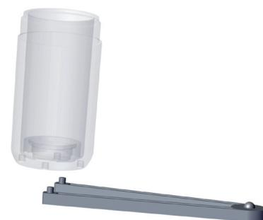
Per lo smontaggio della tazza utilizzare una chiave a compasso. La tazza trasparente permette il controllo del livello della condensa per il filtro o dell'olio per il lubrificatore.
