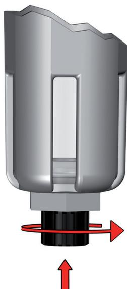
Lo scarico della condensa Manuale / Semiautomatico è normalmente nella posizione aperta cioè scarica automaticamente la condensa quando è assente la pressione nella tazza, premendo la manopola è possibile scaricare la condensa in presenza di pressione, ruotando la manopola in senso antiorario lo scarico è nella posizione chiusa.
