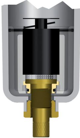
Lo scarico di condensa automatico è disponibile per le misure FRL2 e FRL3 . Il suo funzionamento è di tipo a galleggiante cioè scarica la condensa quando questa raggiunge il livello impostato indipendentemente dalla pressione di utilizzo.
