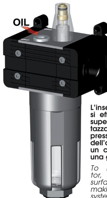
L'inserimento dell'olio nel lubrificatore si effettua svitando il tappo posto sulla superficie superiore oppure smontando la tazza accertandosi prima che non vi sia pressione nell'impianto. La regolazione dell'olio nel circuito si effettua agendo con un cacciavite sullo spillo e impostando una goccia di olio ogni 300-600 NI/min.
