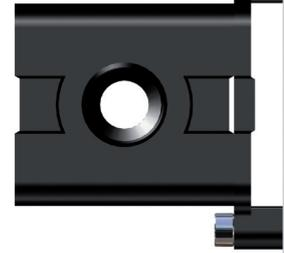
L'elemento utilizzato per il fissaggio dei gruppi di trattamento dell'aria a parete può svolgere la funzione di distanziale: è sufficiente svitare tale elemento, ruotarlo e riavvitarlo. Il distanziale permette così il fissaggio dei gruppi di trattamento dell'aria sulle superfici non perfettamente piane e disconnesse.
