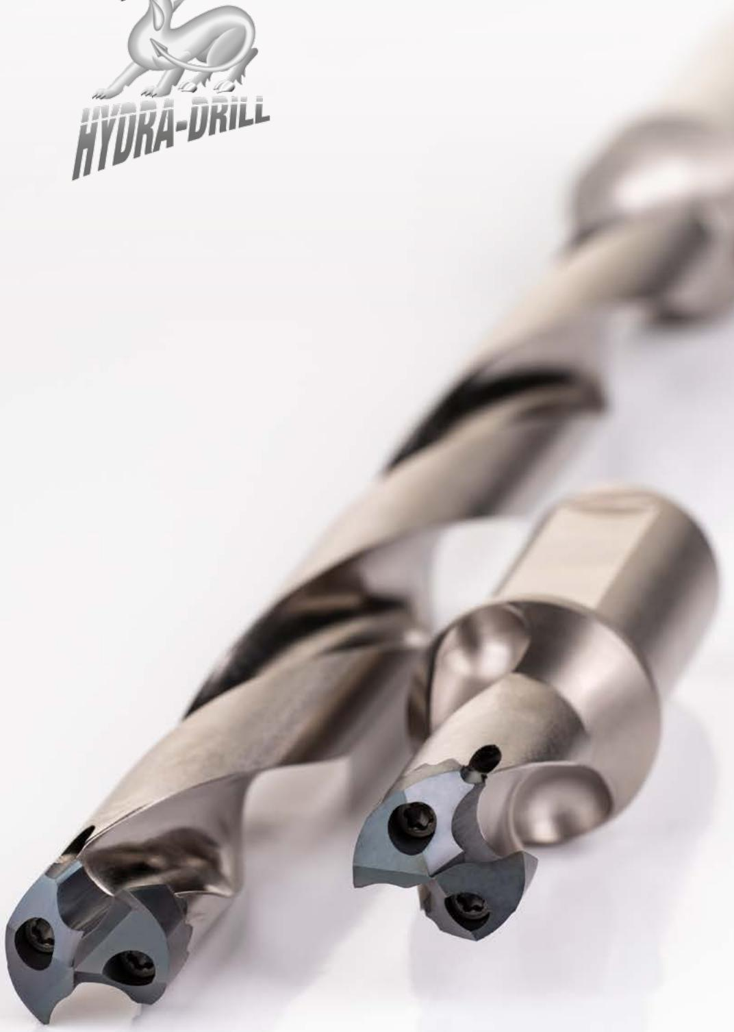
Het Hydra boorprogramma is aangevuld met de extra boorlengtes tot 12xD en 1,5xD. Hiermee ontstaat de mogelijkheid om nog diepere gaten te boren. Daarbij is het gewenst om een startgat te boren en daarvoor is de 1,5xD versie geschikt. Tevens kan deze laatste worden gebruikt voor het boren in dunnere platen.
