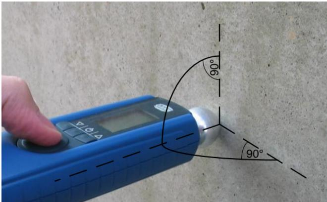
Abbildung 4-3 Messung möglichst senkrecht zur Messfläche
