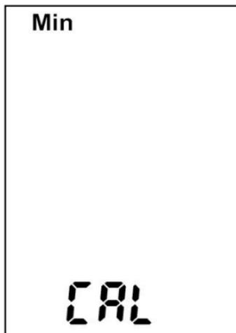
**Signalisiert die Abspeicherung des Min-Wertes 0, d.h. als Minimalwert wird „0“ festgelegt**
