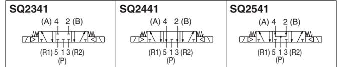
Dual 3 port valve: SQ2<sup>A</sup>/<sub>B</sub>41<sup>C</sup>
